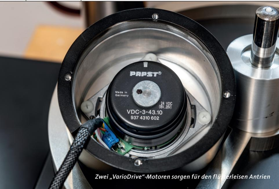
Zwei „VarioDrive“-Motoren sorgen für den flüsterleisen Antrieb
