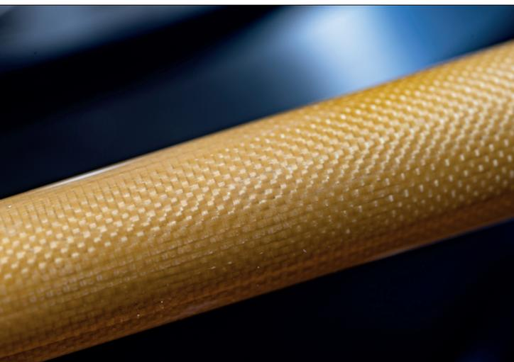
*Kevlar (auch Aramid genannt) in seiner ganzen gewebten Schönheit: das Tonarmrohr des KV-12*
